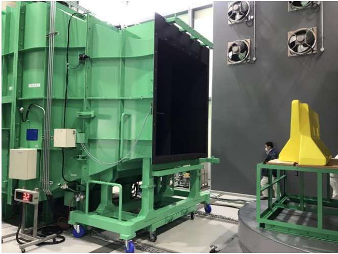
送風機吹出口から試験体表面まで 2,000 mm、風向は正面 1 方向
