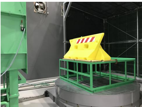
送風機吹出口から試験体表面まで 2,000 mm、風向は正面 1 方向
