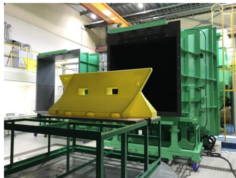
送風機吹出口から試験体表面まで 2,000 mm、風向は正面 1 方向
